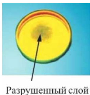
Рис. 4. Фильтр с разрушенным участком поверхности.
