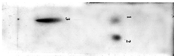
Рис. 6. Хроматограмма верапамила, изолированного из плазмы крови 1. верапамил, выделенный из плазмы (1 мкг/мл); 2. стандарт верапамила; 3. фосфолипиды, содержащиеся в плазме
